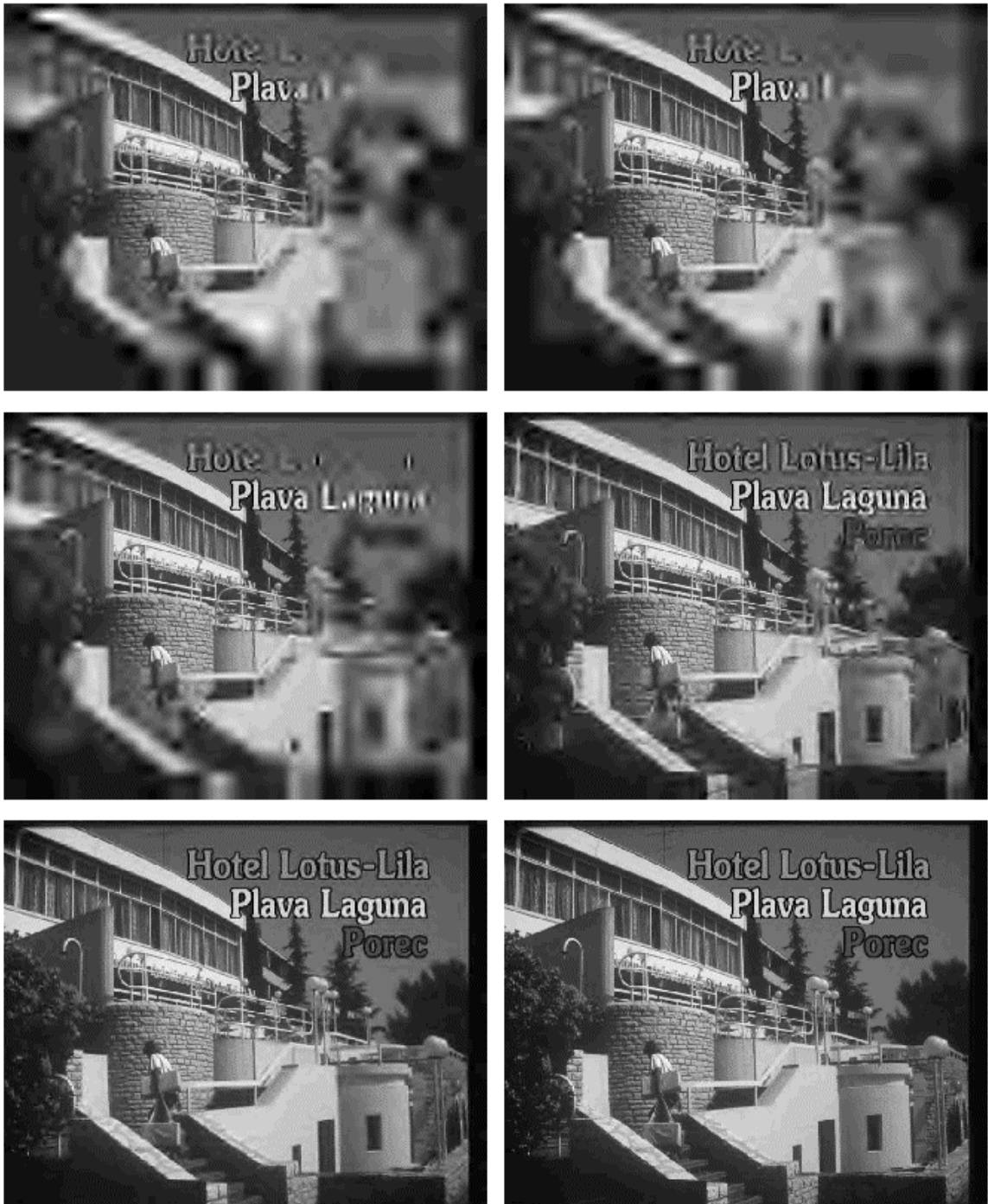
Figura 71: Esempio di codifica della ROI. Le immagini sono codificate, rispettivamente, a 0.0625, 0.125, 0.25, 0.5, 1.0, 2.0 bpp.
